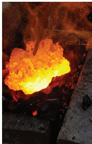
Železna kocka po gnetenju na kovaškem ognjišču
